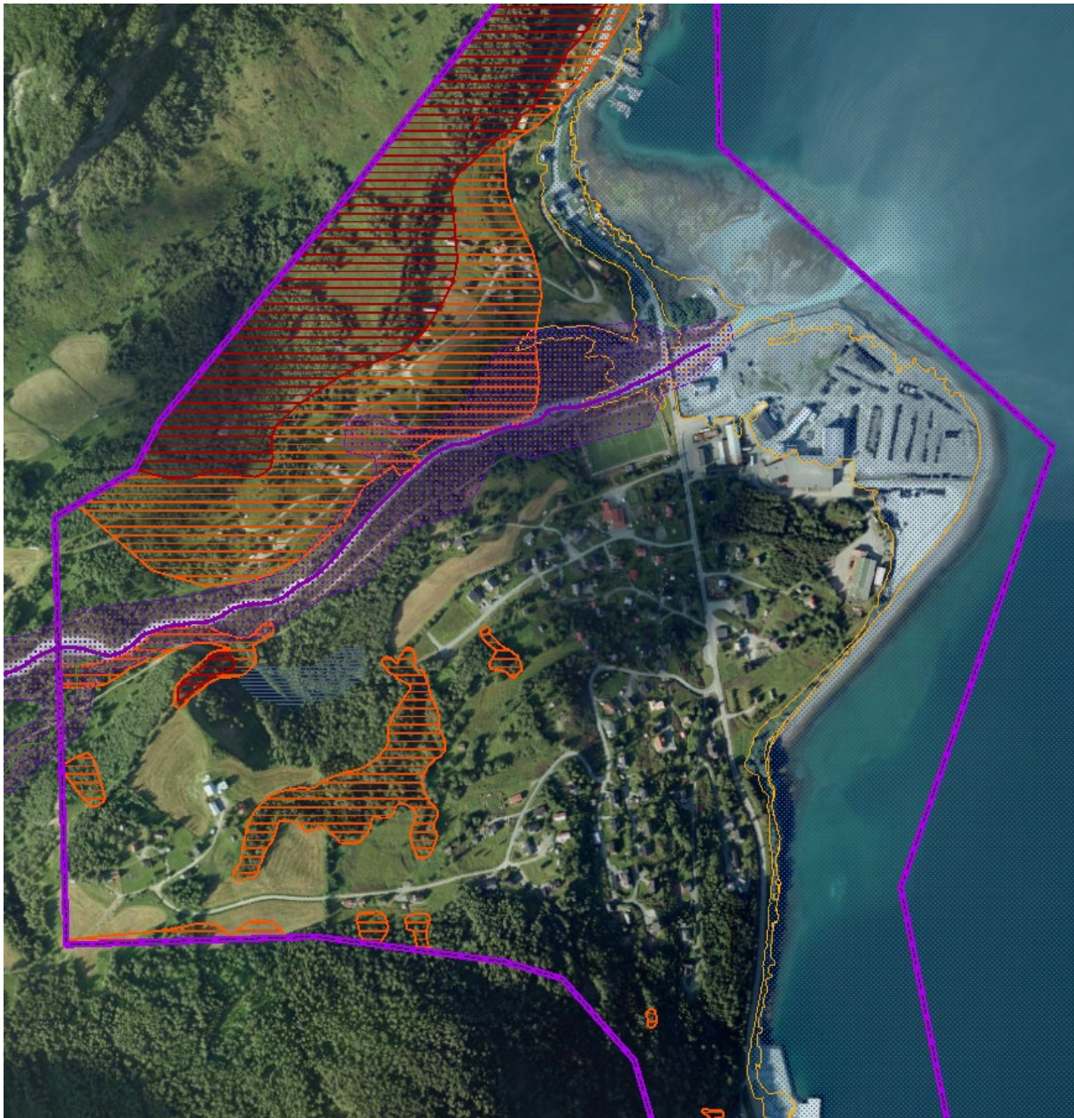
Figur 10 Areal som det kan byggjast tiltak med tryggingssklasse S2 er synt utan skravur innanfor fiolett line, minus dyrka mark, myr og eksisterande utbygd areal.
