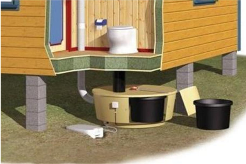
Figur 9. Eksempel på biologisk toalett løsning (nibio.no).
