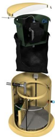
Figur 7 Prinsippkisse for slamfilter (nibio.no)
